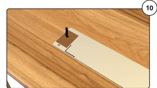
10 Doppelkleber links und rechts anbringen (Schutzfolie von Doppelkleber entfernen).
