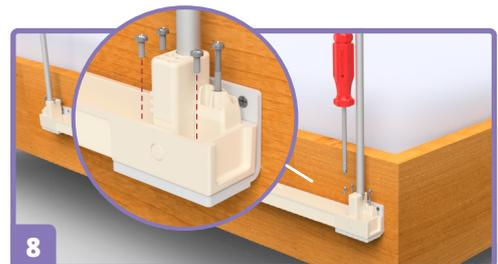
8 Montare di nuovo l'AIRZAG. Fissare su ogni lato con quattro viti.
