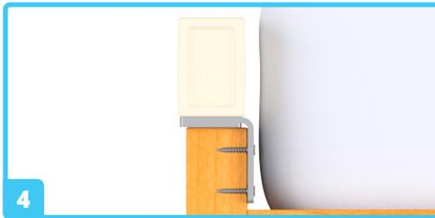
4 Avvitare le viti nel telaio del letto nella parte posteriore di entrambi gli angoli.
