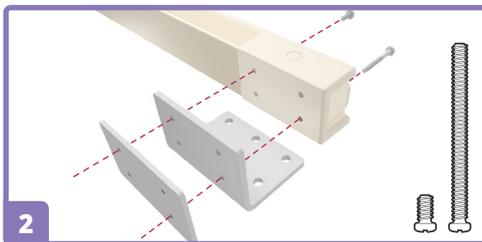
2 Fissare provvisoriamente con 2 viti diagonalmente gli angoli con le piastre filettate all'AIRZAG.
